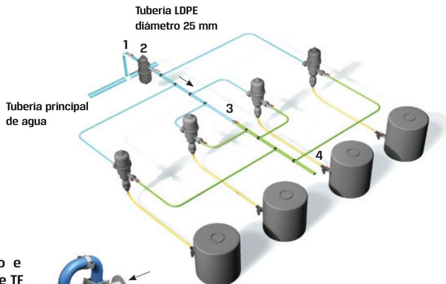
**Combinación de estación principal de filtrado e instalación en derivación del inyector MixRite TF**
