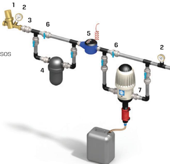
**Instalación de tubería plástica con derivación de 4 aditivos diferentes**
