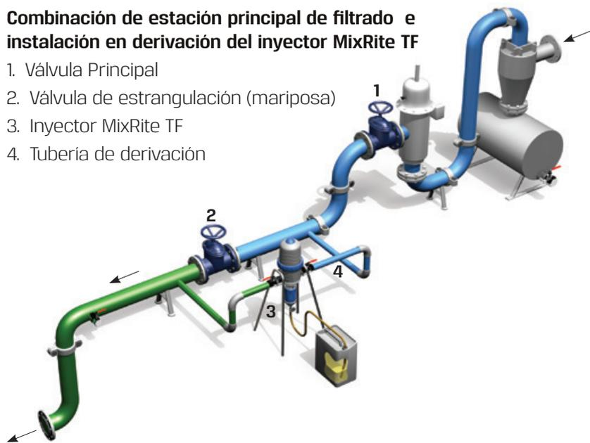
**Instalación típica de conjunto con derivaciones para tres inyectores modelos MixRite TF**
