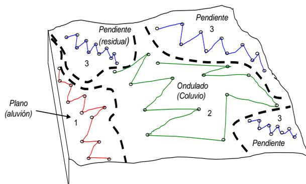
Fig. 4. Diagrama de muestreo de suelos. Las unidades de muestreo están separadas por la línea intermitente gruesa. Note que se definen tres unidades de muestreo (1, 2, 3). Note que tres muestras se toman en este caso. Cada punto, representado por un círculo abierto, es una submuestra.
