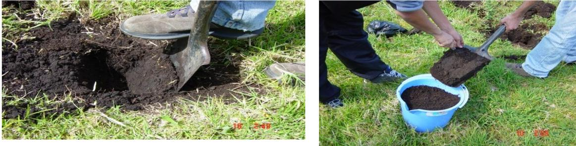
Fig. 5. Toma de muestra con pala (arriba) y su transferencia a un balde. La Ceja, Antioquia.
