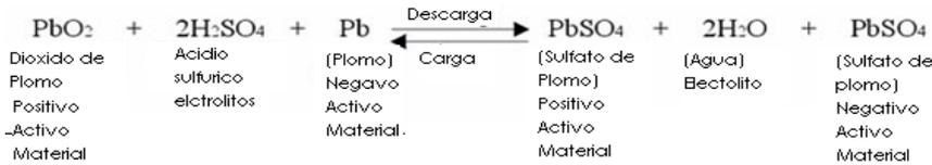
En esta reacción, la carga y descarga se invierten con alta eficiencia. La energía eléctrica utilizada durante la descarga se recuperó después de recargarla.
